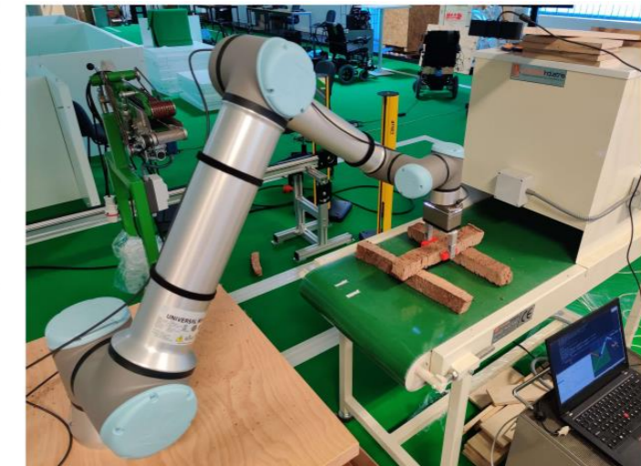
Resultado da aplicação de um conjunto de trajetórias globais com a finalidade de agarrar um traço
