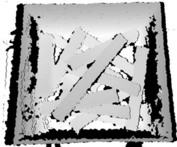
Solução integrando visão e eixos robotizados para manipulação de traços de cortiça na sua perfuração automatizada
