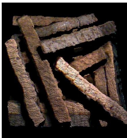
Segmentação da nuvem de pontos assim como seleção e identificação de um traço e suas posição e orientação relativas
